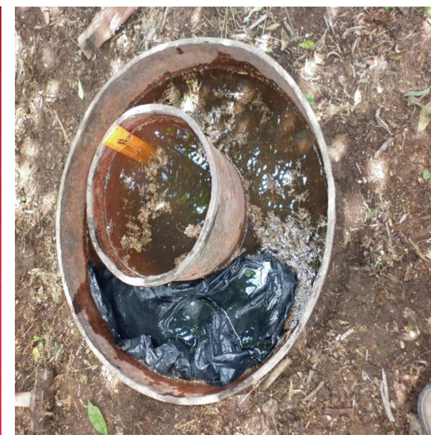
Prueba de infiltración de agua
